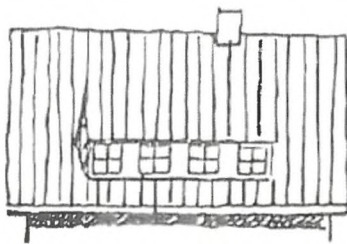
Breite Schleppgauben wirken durch die einheitliche Dachdeckung kaum störend.
